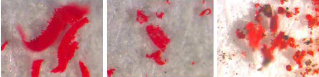
Şekil 9: Sırasıyla yeni boyanmış, iyi ve kötü muhafaza edilmiş tuval bezlerinden alınmış boya pigment partiküllerinin mikroskopik görüntüleri
