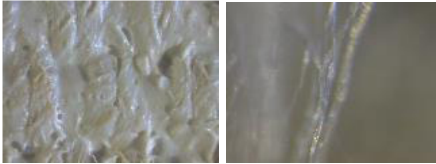
Şekil 6: Temiz ve kullanılmamış tuval bezinin ve bezdeki lifin mikroskopik görüntüleri
