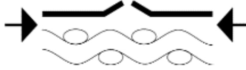
Şekil 1: Tuvaldeki büzülmenin boyayı sıkıştırması sonucu boya yüzeyinde neden olduğu çatlamlar (Andersen ve diğ., 2016, s.17).
