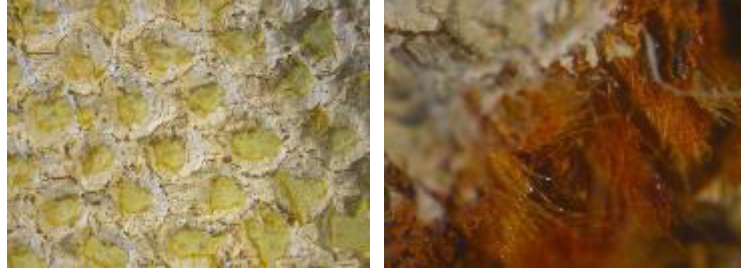
Şekil 7: Kötü muhafaza edilmiş tuval bezinin ve bezdeki liflerin mikroskopik görüntüsü
